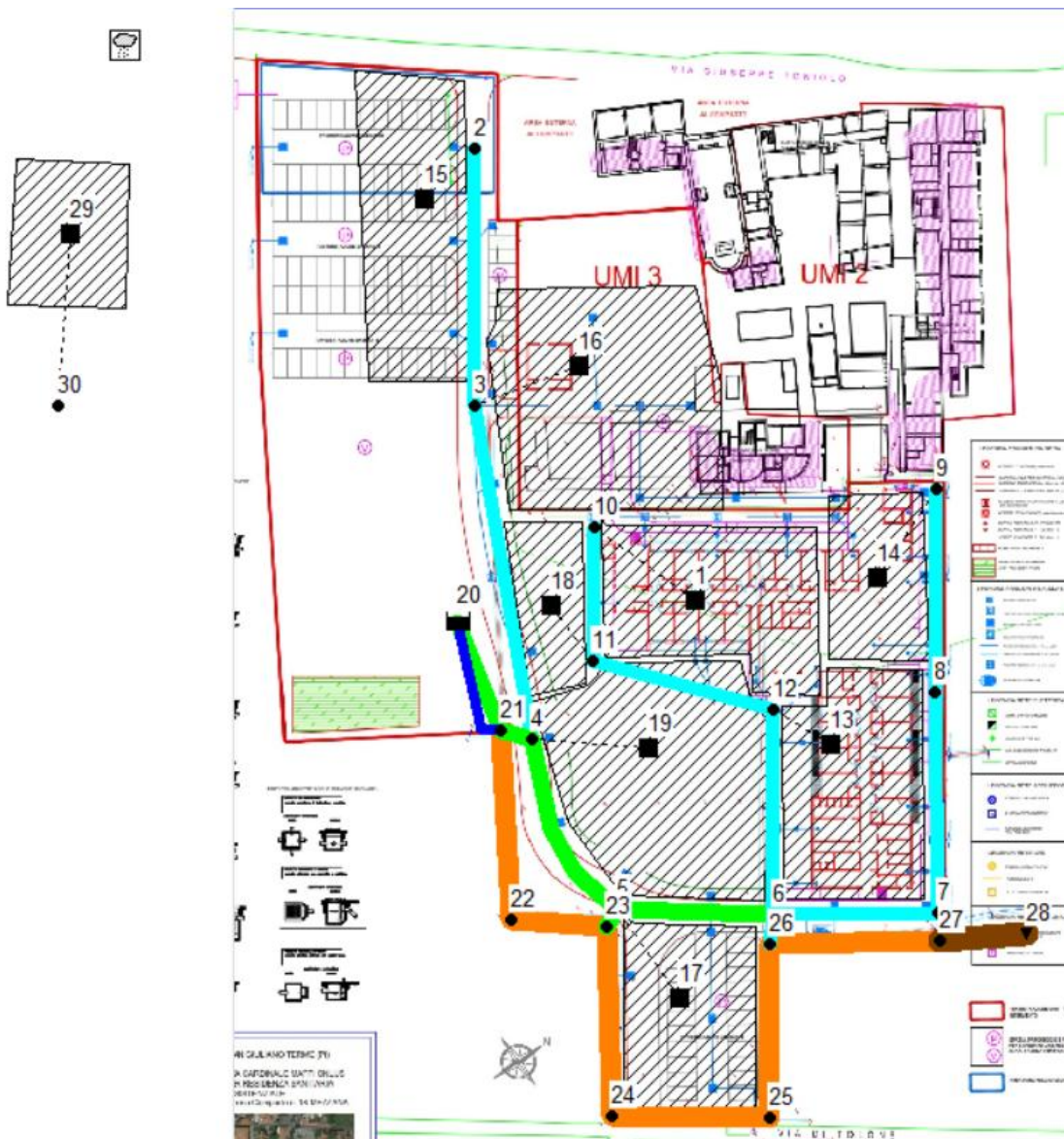
Schema idraulico con i nodi della rete: il nodo n. 30 sintetizza i dati del bacino stato attuale.
